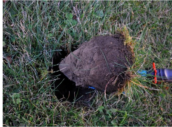
Abb. 2 Die Bodenprobe ist nur im oberen Bereich feucht. Der helle Bereich unten ist trocken sowie staubig. Der Sand rieselt herunter.
