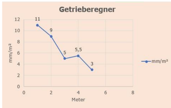
Abb. 7 Einzelregner Gardena Versenkregner Aqua Contour automatic Messwerte
